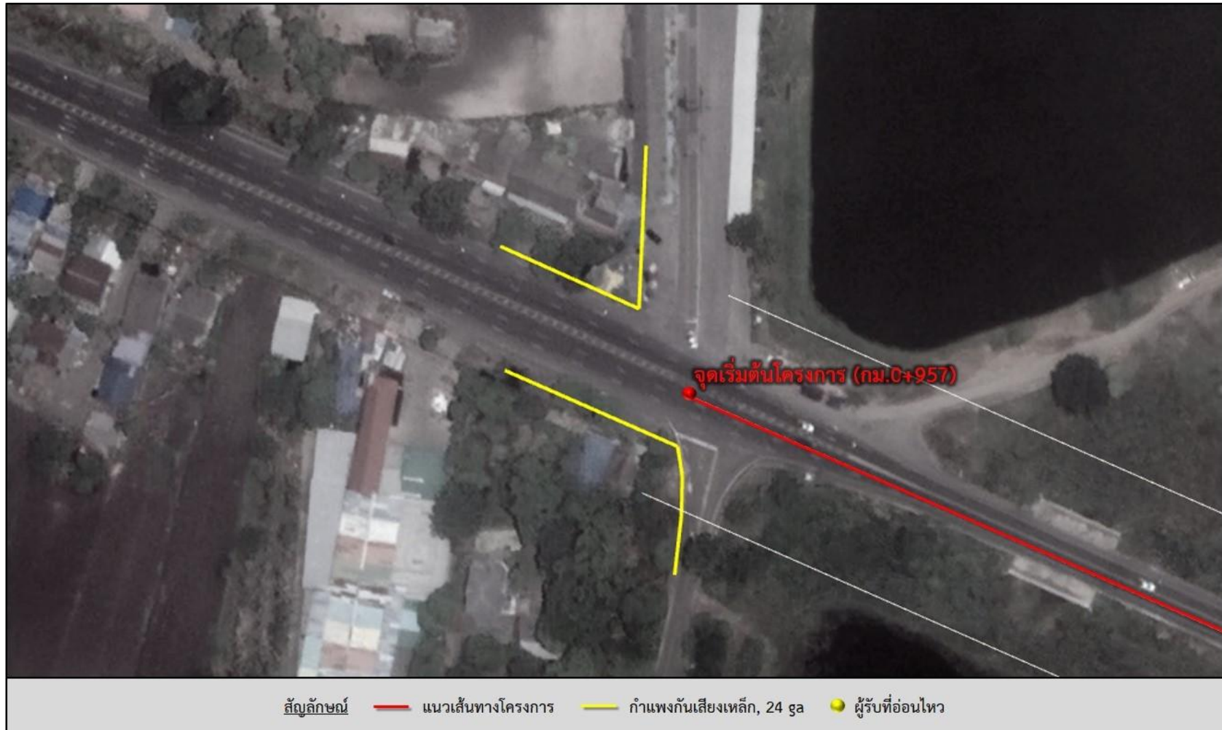
รูปที่ 4.5.1-6 ตำแหน่งติดตั้งกำแพงกันเสียงในระยะก่อสร้าง
